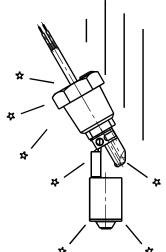
Durante le fasi di stoccaggio e di montaggio, non far subire colpi al sensore, che rischiano di modificare le sue caratteristiche
