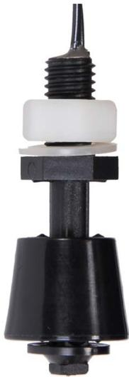
Ce détecteur de niveau en polypropylène, livré avec écrou et rondelle d'étanchéité, se fixe par l'intérieur de la cuve. De faible encombrement, seulement 48 mm de long, il convient parfaitement aux applications en eau jusqu'à 80°C. La position du flotteur sur le corps permet d'inverser le sens du contact (à déterminer à la commande).
